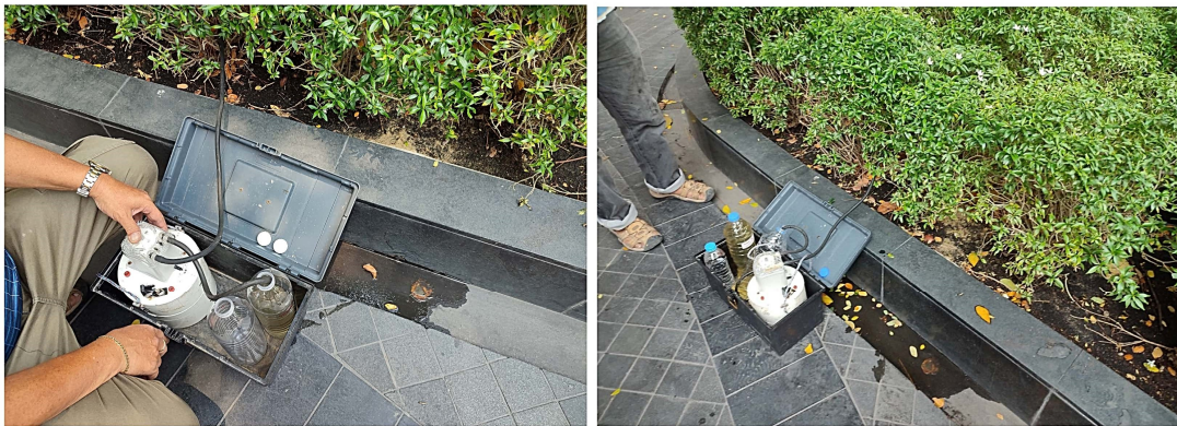
เก็บตัวอย่างน้ำทิ้งที่ป้อปรับสมดุลน้ำเสีย และพักน้ำเสียหลังจากจากระบบบำบัดน้ำเสีย ด้วย Sampling Pump
